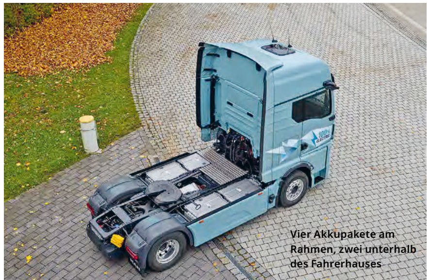
Neben den beiden Akkupaketen finden sich auch die Hochvolt-komponenten unter der Kabine
