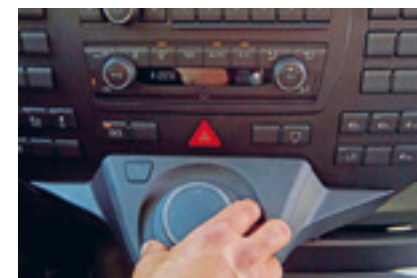
Anstelle von Touchscreens setzt MAN auf einen Dreh-Drück-Steller, der sich bestens bedienen lässt
