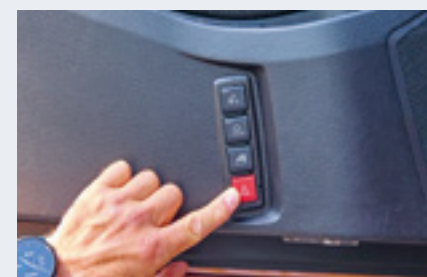
Nach wie vor eine gute Idee: In der Fahrertür integriertes Bedienmodul für wichtige Funktionen
