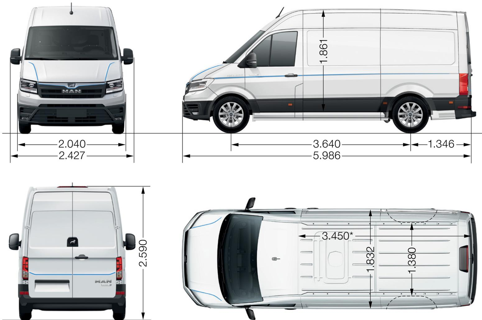
\* Länge Fahrzeugboden inkl. Unterladefähigkeit unter Trennwand. Ladelänge im oberen Bereich: 3.201 mm.
