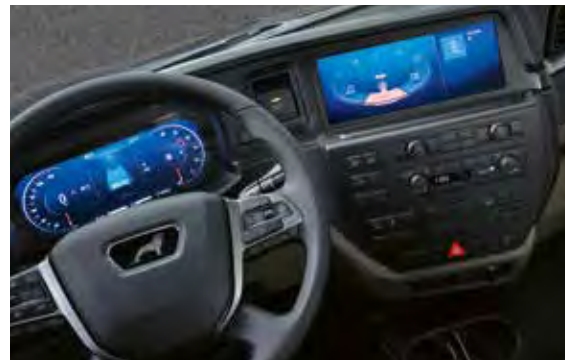
Infotainmentsystem mit 12-Zoll-Display und Bedienfeld unterhalb des Sekundärdisplays
