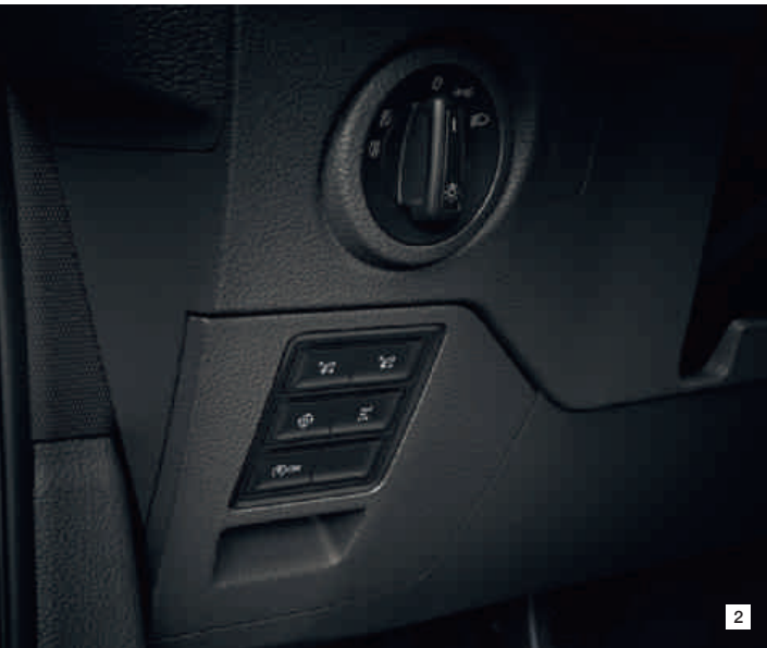
1 – Kastenwagen Plus (verfügbar in verschiedenen Fahrzeuglängen und -höhen); 2 – Separates Bedienfeld für die Aufbausteuerung, vom Fahrersitz oder von aussen bedienbar; 3 – Abschleppfahrzeug
