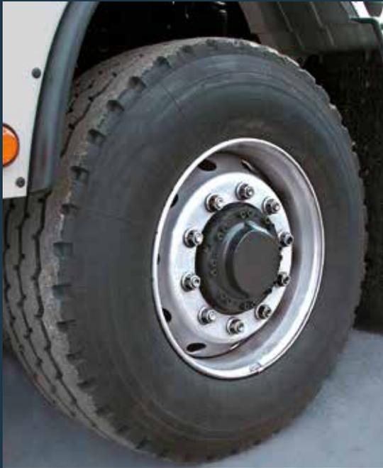
Vorderachse mit hydrostatischen Radnabenmotoren.
