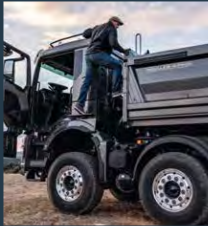
Bauaufstieg mit Haltereling auf dem Dach.
