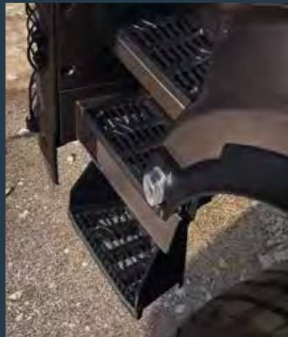
Untere Trittstufe mit Pendelfunktion aus besonders elastischem Kunststoff.
