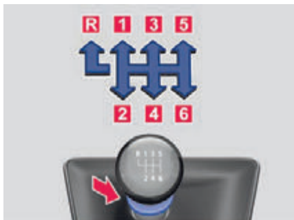
Abb. 91 Schaltschema des 6-Gang-Schaltgetriebes.
