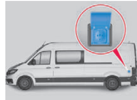
Abb. 125 In der linken Seitenwand außen: 230-Volt-Außensteckdose.
