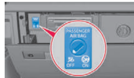
Abb. 38 Im Handschuhfach: Schüsselschalter zum Ab- und Einschalten des Beifahrer-Frontairbags.
