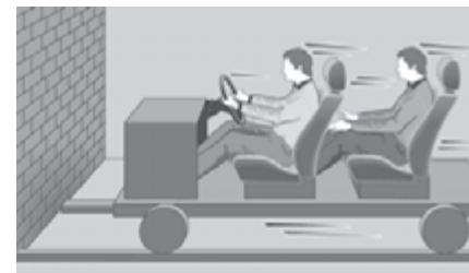
Abb. 24 Ein Fahrzeug fährt mit nicht angegurten Fahrzeuginsassen auf eine Mauer zu.
