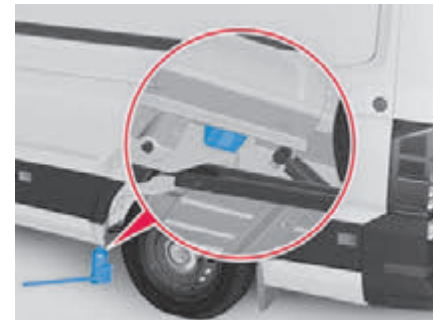
Abb. 209 Kastenwagen: Aufnahme- punkte für den Wagenheber hinten.
