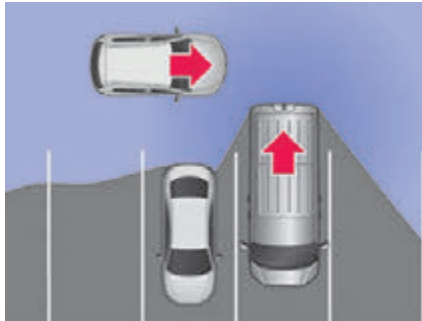
Abb. 116 Prinzipdarstellung Ausparkassistent: Überwachter Bereich um das ausparkende Fahrzeug.
