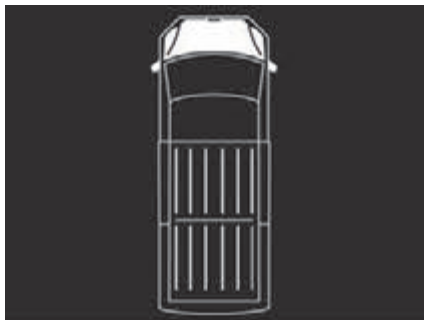
Abb. 173 Prinzipdarstellung im Display des Kombi-Instruments: Frontklappe geöffnet oder nicht richtig geschlossen.
