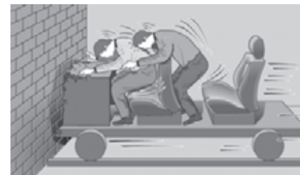
Abb. 25 Ein Fahrzeug fährt mit nicht angegurten Fahrzeuginsassen an die Mauer.
