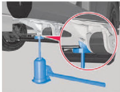
Abb. 206 Pritsche und Fahrgestell: Aufnahmepunkte für den Wagenheber hinten bei Einfachbereifung.
