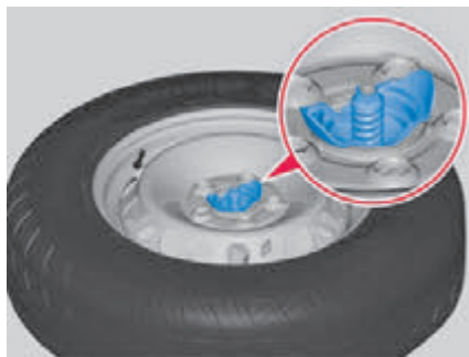
Abb. 200 Korrekter Sitz des Felgenhalters im Felgenloch.
