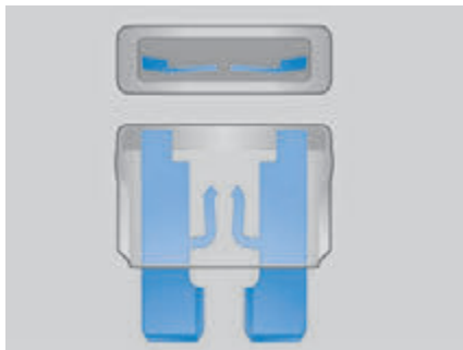
Abb. 165 Darstellung einer durchgebrannten Sicherung.
