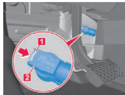
Abb. 188 Im Fahrerfußraum: Batteriehaupschalter Elektroanlage ausschalten.
