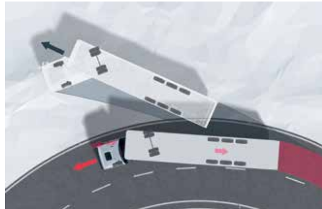
ESP-Ausgleichsbremung beim Übersteuern des Zugfahrzeugs.
