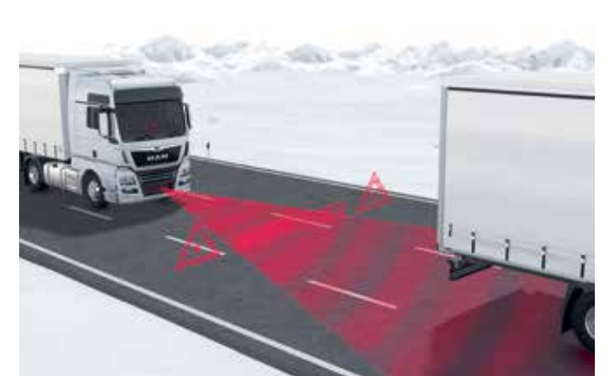
EBA-Funktionsprinzip: Verkehrsraumüberwachung durch Nutzung zweier unabhängiger Sensorsysteme (Radar und Video).
