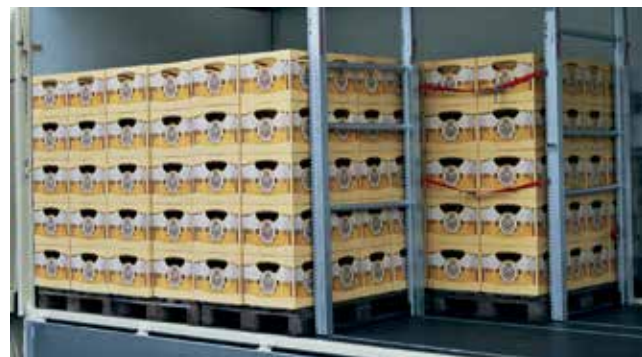
Beispiel: Ladungssicherung durch Aufbau nach VDI-Richtlinie 2700
