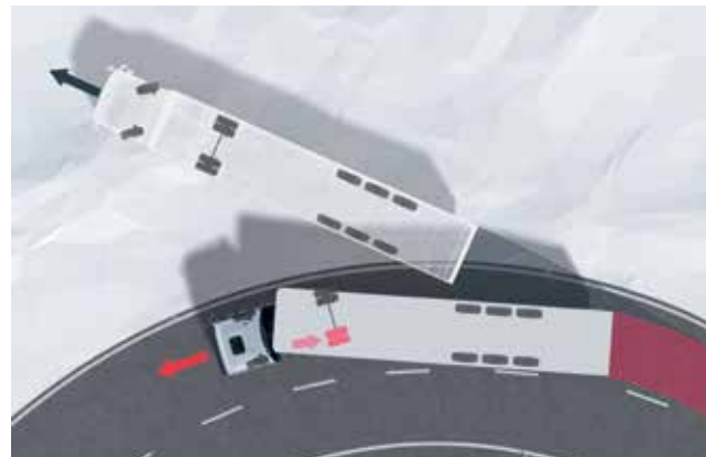
ESP-Ausgleichsbremung beim Untersteuern des Zugfahrzeugs.
