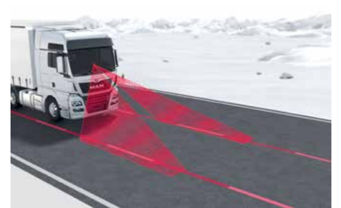
Spurhalteassistent (LGS) inkl. Spurrückführungsassistent (LRA)
