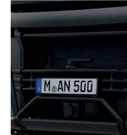
Stahlstoßfänger mit mittig angeordnetem Schleppmaul hinter Kfz-Kennzeichen und klappbarem Frontaufstieg, stabiles Steinschlagschutzgitter vor dem Kühler.
