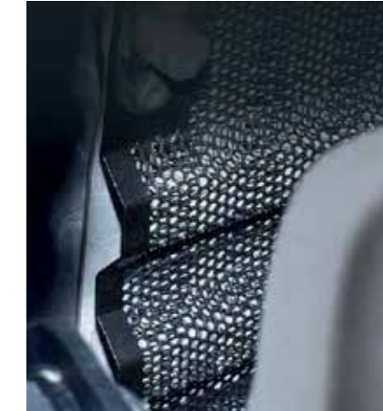
Schutzgitter vor Kühler.
