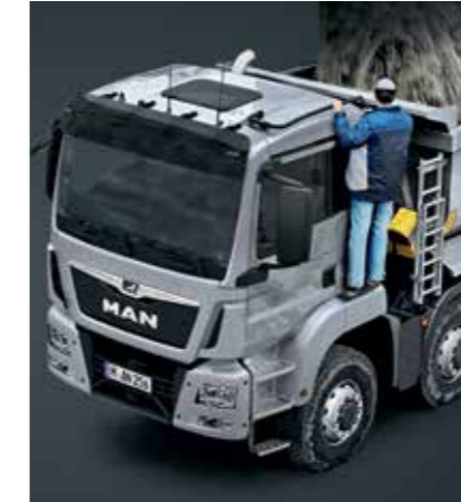
Bauaufstieg mit Haltereiling auf dem Dach.
