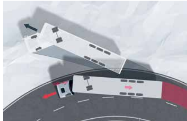
ESP-Ausgleichsbremung beim Übersteuern des Zugfahrzeugs.
