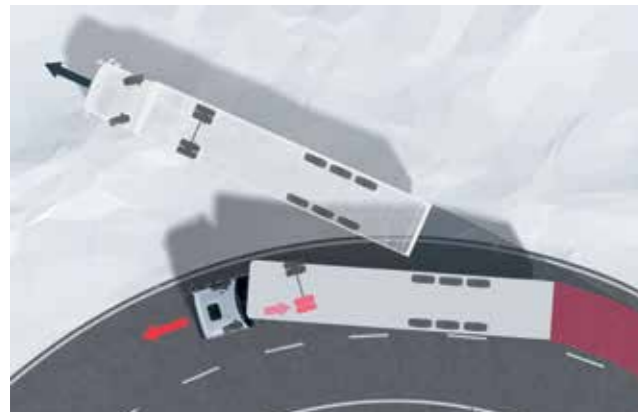
ESP-Ausgleichsbremung beim Untersteuern des Zugfahrzeugs.
