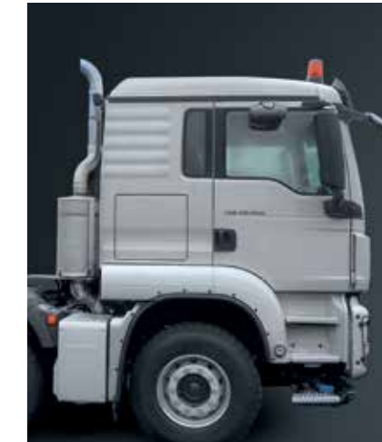
Teilhochgestellte Abgasanlage für L-Fahrerhaus.
