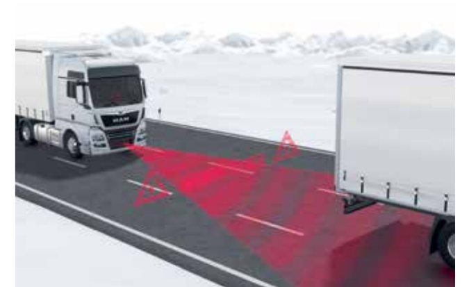
EBA-Funktionsprinzip: Verkehrsraumüberwachung durch zwei unabhängige Systeme (Radar und Video).
