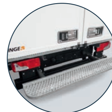
Heckauftritt, feststehend In fast ganzer Fahrzeugbreite montiert.
