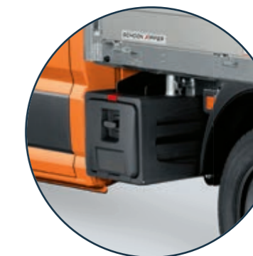
Werkzeugkasten Unter der Ladefläche angebracht.
