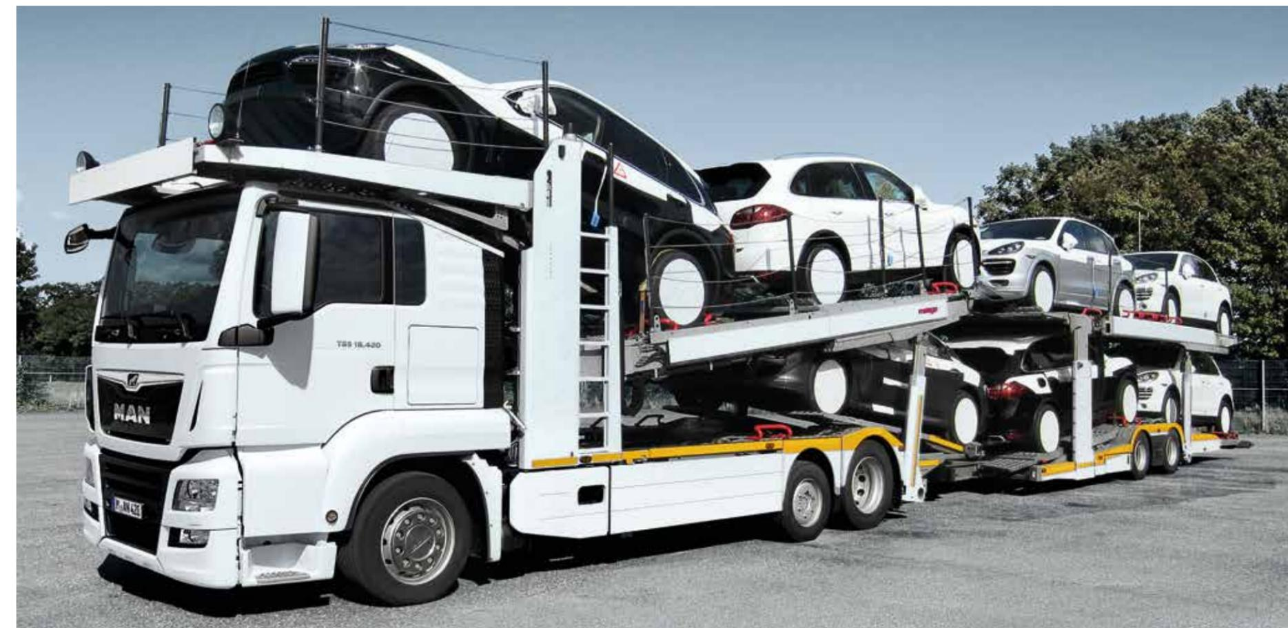
Optimierung Fahrzeughöhe durch Flachdach mit 16°-Schräge, optional Anpassung Fahrerhauslagerung, Montage Vorlaufachse
