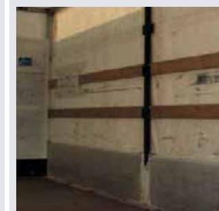
Löcher in der Karosserie, die mit Platten vernietet, unsauber verfüllt oder übersprüht wurden.
