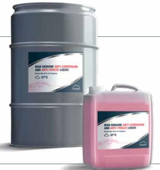
\*MAN Original Korrosions- und Frostschutzmittel (KFM) ist einsetzbar für Motoren aller Abgasstufen, wird im idealen Mischungsverhältnis mit geprüfter Wasserqualität geliefert und ist frei von Nitriten, Aminen und Phosphaten. Es ist allerdings nicht immer mit anderen Kühlmitteln mischbar. Ein Vermischungsverbot besteht für KFM der Norm MAN 248 und für die Typen SNF, N-Arctic und N der Norm MAN 324.
