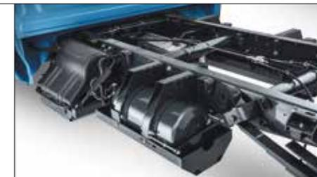
CNG-Tanks mit einem Fassungsvermögen von bis zu 302 Litern/48,7 kg (je nach Ausführung)
