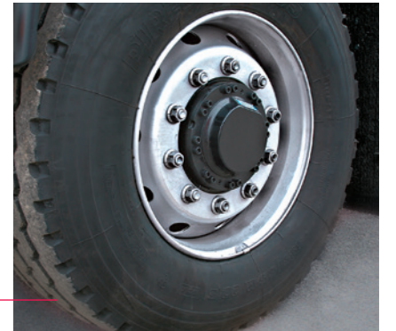
Vorderachse mit hydrostatischen Radnabenmotoren
