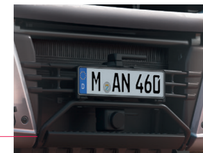
Dreiteiliger Stahlstoßfänger und Steinschlagschutzgitter vor Kühler
