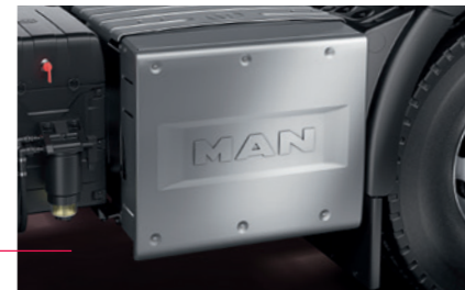
Kompakter Schalldämpfer mit CRT-Filtersystem und SCR-Katalysator.
