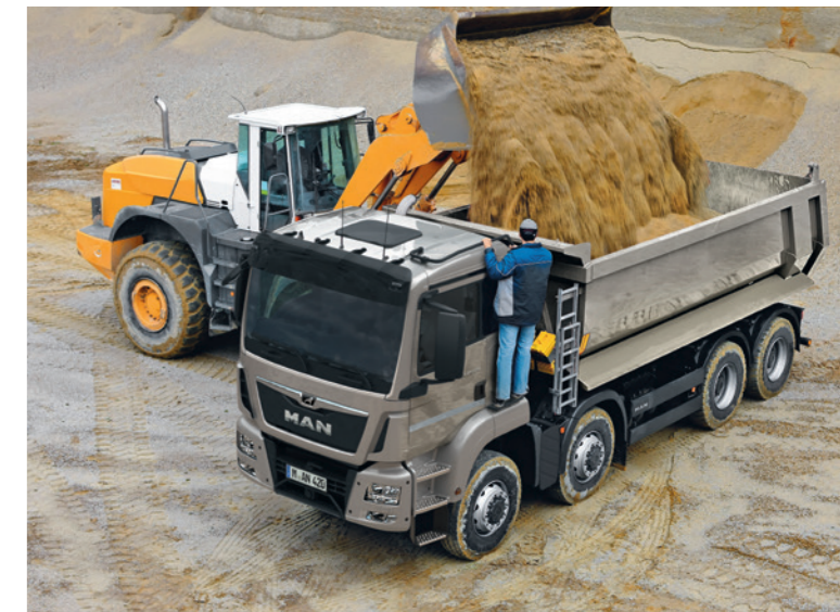
Baufahrt mit Haltereling auf dem Dach.
