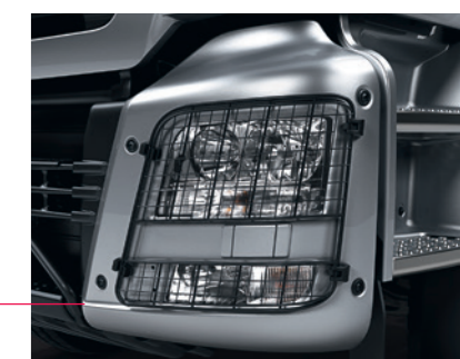
Besonders stabiles Scheinwerfer-Schutzgitter für den Baustelleneinsatz
